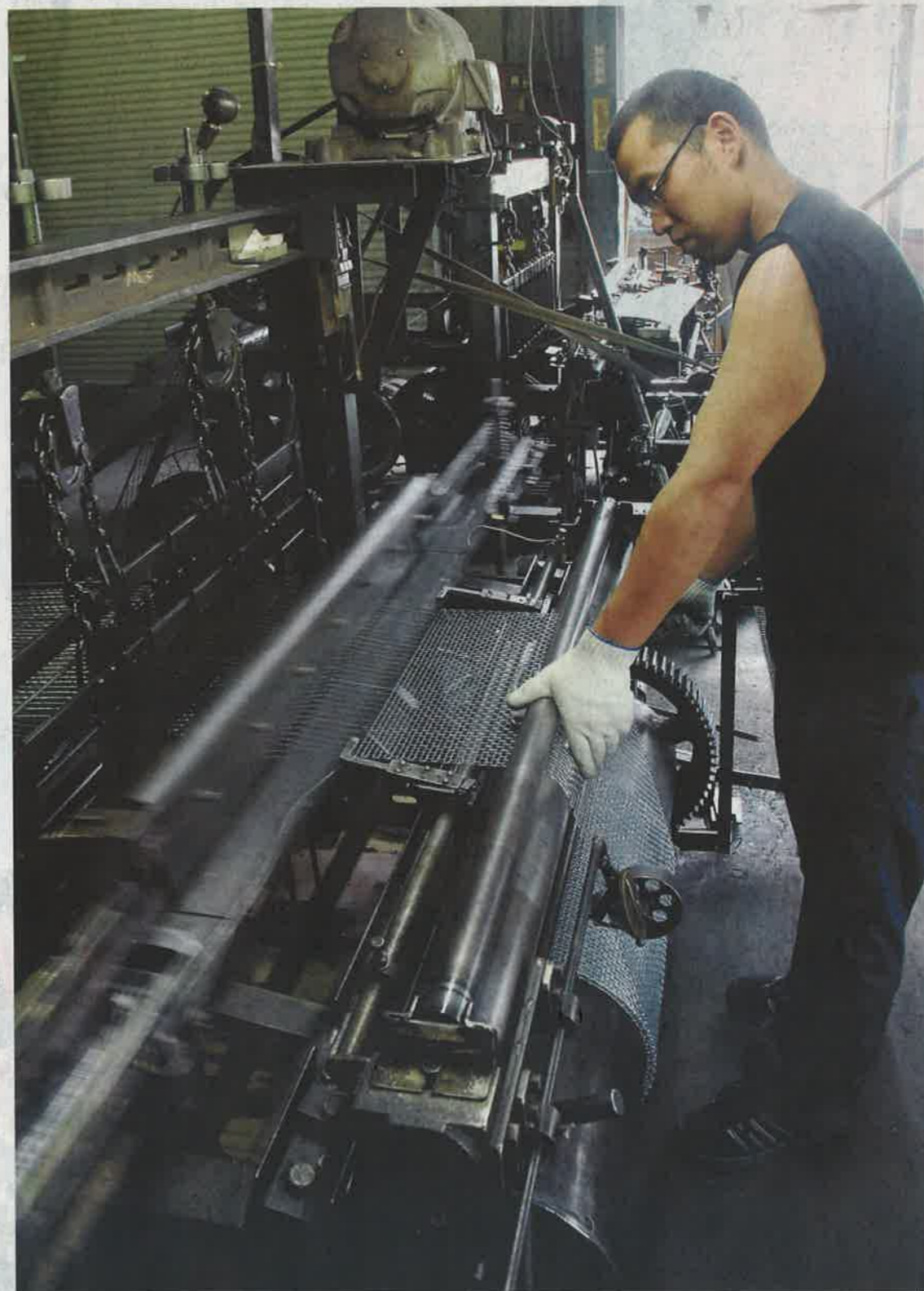
昔ながらの織機で金網を織り込む。線材が幾何学的な模様を紡いでいく ＝山形市鑄物町
